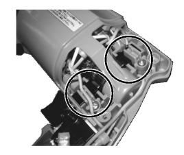
ピストル型タイプでは、カーボンブラシが固定されています。ネジを外して交換してください。
