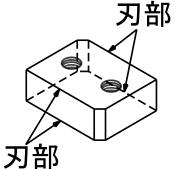
回使用できます。材料を約2000本位切断しましたら摩耗・変形・欠けのない刃 部を使用するようにカッターブロックの取付け向きを替えるか、または新しいカッ ターブロックと交換してください。
