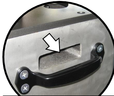
鉄筋屑取り出し用窓
