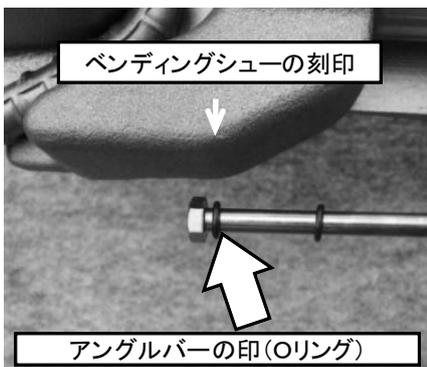
ベンディングシューには矢印の刻印がされています。同じ曲げ角度で多数加工をする時などは、あらかじめテスト曲げで得た角度の位置で、アングルバーの印(リング)をベンディングシューの刻印と合わせるようにしておき、次回以降の曲げ加工時の目安とすると便利です。本機は少しずつピストンを前進させながらの曲げ加工が可能です。微調整で得た角度を設定する
