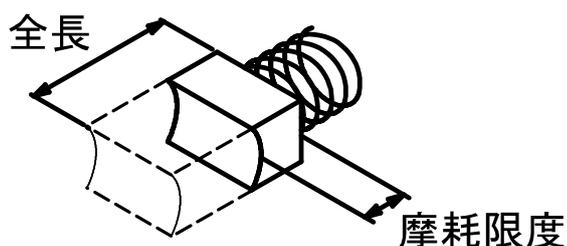
カーボンブラシの交換の際はセットで交換します。
