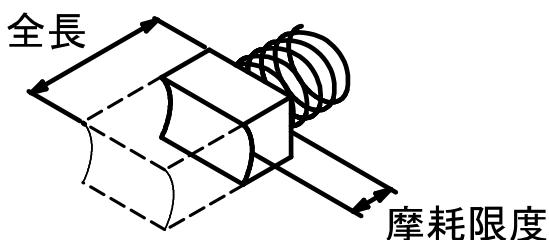
カーボンブラシの交換は、モーターハンドルカバーを外して、セットで交換します。
