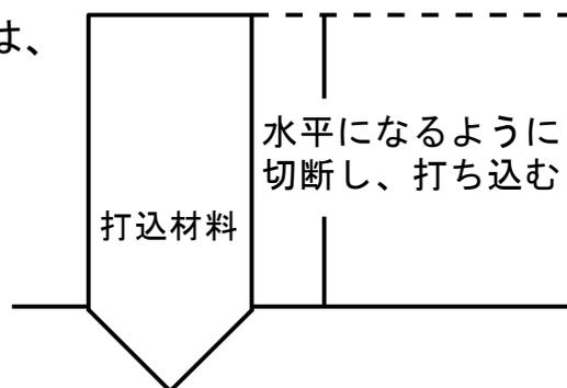
◆打込み材料の形状と径(太さ)を確認してください。
