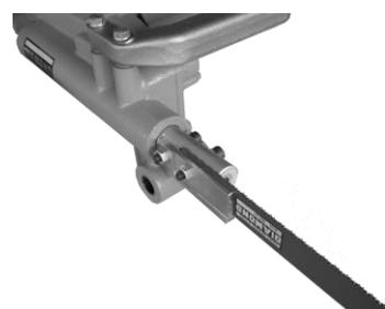
3. 付属のスパナ（10mm）と六角棒レンチ（6mm）を使用して、六角穴付きボルトと、ナットをしっかりと締めつけます。
