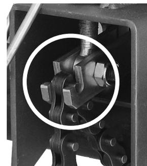
3. セットレバーを回し、確実にクランプします。セットレバーを回すことで、チェーンレバーが上昇します。
