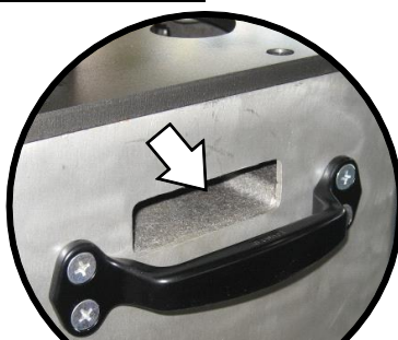
鉄筋屑取り出し用窓
