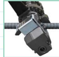
接着系アンカー施工のボルト作成がすぐにできます。
