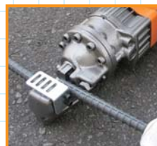
■D16鉄筋を2秒で切断
