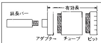
ビット・チューブ・アダプターの3点からなる専用コアビットです。深く穿孔する時はチューブを継ぎ足すか延長ロット棒をご使用ください。
