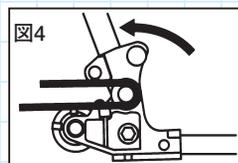
先端部の溝は90°曲げの目安です。左右の溝をそろえた状態が90°となります。
